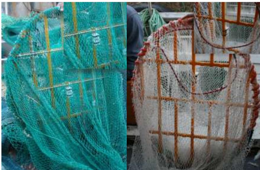
Figura 19. Sensore STAR-ODDI per il rilevamento dell'angolo di inclinazione della griglia montato sulla FLEXGRID.
