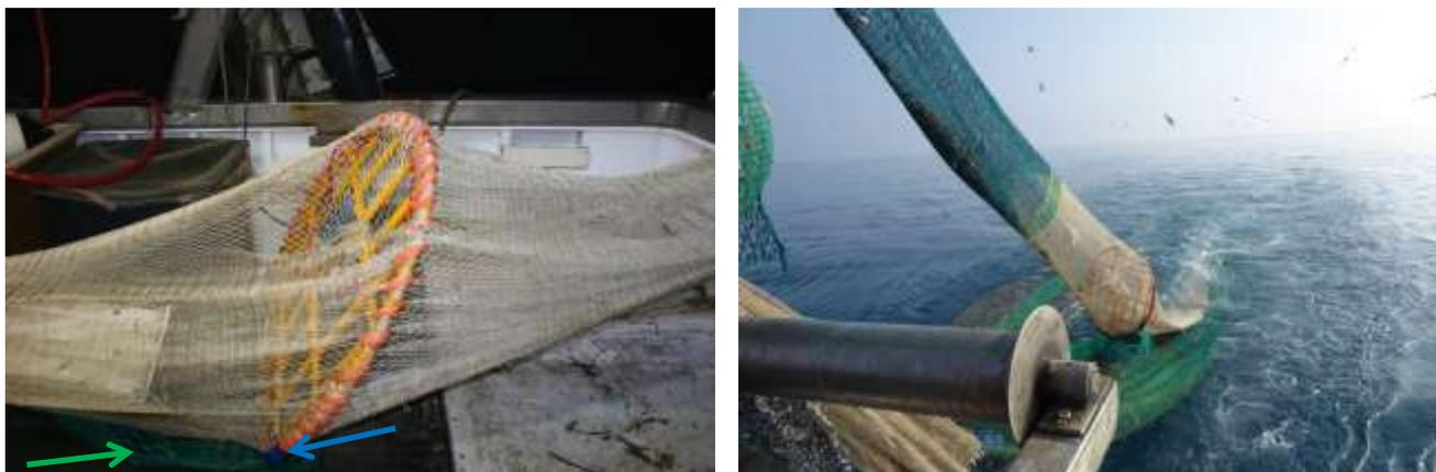
Figura 12. FLEXGRID impiegata per le prove in mare: a sinistra, dettaglio della rete di protezione del lato inferiore della griglia (in verde) e del rivestimento di protezione in plastica applicato direttamente sulla griglia (in blu); a destra, *grid section* in fibra Chineema.
