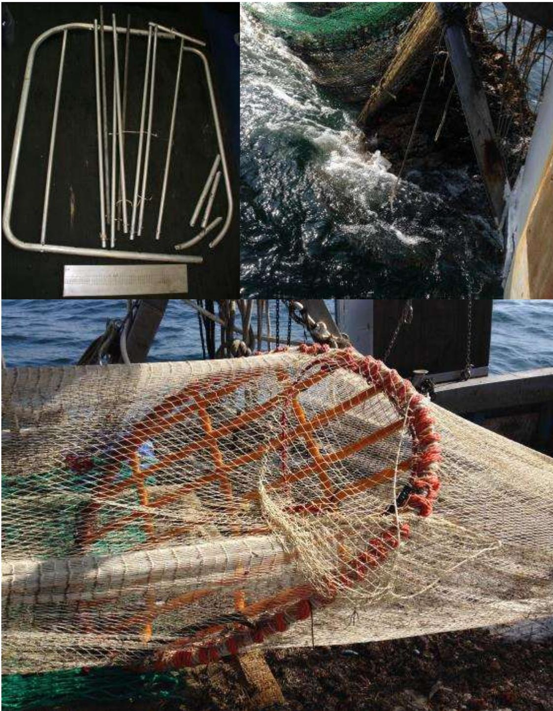
Figura 46. Problematiche a bordo: rottura del TED. In alto: a sinistra rottura di uno dei TED testati in TARTANET; a destra, scoglio preso durante una cala con FLEXGRID; in basso, FLEXGRID intatto durante la salpa nonostante l'impatto e il peso dello scoglio.
