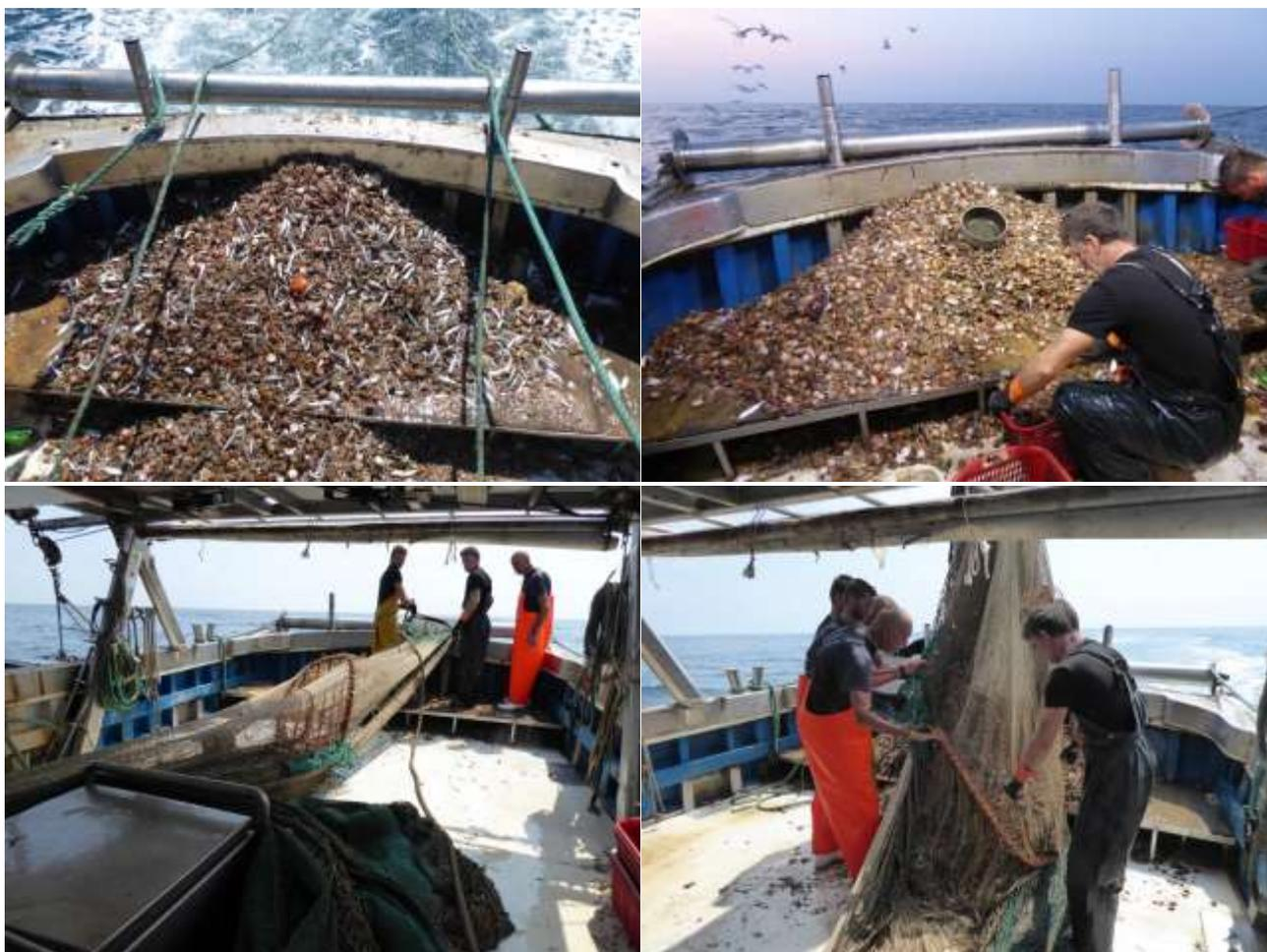
Figura 37. In alto: cattura con FLEXGRID (a sinistra) e con rete tradizionale (TRADIT) a destra. In basso, flessibilità del TED sottoposto ad elevati carichi e sollecitazioni in fase di salpa.
