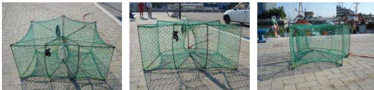
Figura 25. Modello professionale a singola camera: con dimensioni di 60 cm in altezza e di 140 cm in larghezza, struttura portante con barre d'acciaio (diametro 6 mm), rete esterna in plastica (polietilene) di colore verde chiaro.
