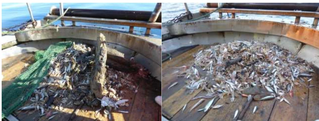
Figura 34. A sinistra, saccata con rete tradizionale (TRADIT) e a destra saccata con FLEXGRID. Si nota come i grossi tronchi sono espulsi dalla griglia, mentre nel sacco della rete con il TED, il debris legnoso è costituito solo da piccoli pezzi.
