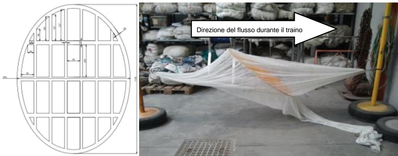
Figura 15. Caratteristiche tecniche della griglia di esclusione (*Bycatch Reducer Device Mod. FLEX-GRID*) sperimentata a bordo dei pescherecci commerciali a volante (sinistra); dettaglio della griglia utilizzata nella sperimentazione e montata su una sezione dell'avansacco. Nella parte inferiore è visibile il sacco di raccolta (*Collecting Bag*) utilizzato per raccogliere le specie e il materiale deviato verso l'esterno dalla griglia (destra).
